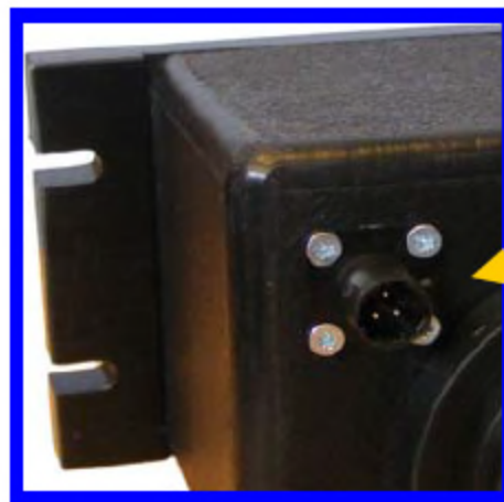
Steckverbindungen zu Mikroschalter an der Rückseite der Einheit
