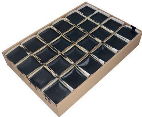
La massa isolante per fughe raccomandata viene riscaldata fino a 160° – 180° C mescolando continuamente. L'applicazione viene eseguita utilizzando un recipiente con beccuccio o una lancia di colata; la massa isolante in eccesso dovrà essere rimossa meccanicamente al termine del raffreddamento.
