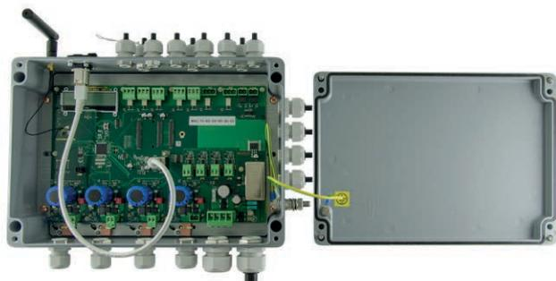
L'unità di comando per tutti i sistemi GIFAS sono predisposte per 4 linee di uscita. Ogni canale può reggere un massimo di 10 A.
